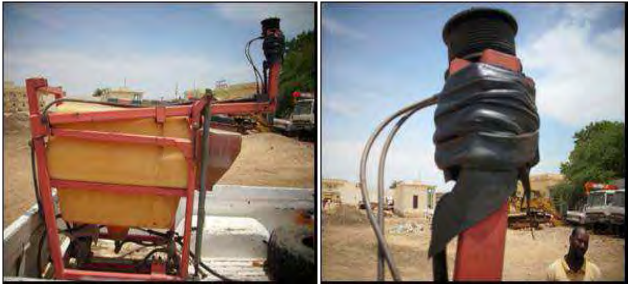
Photos 2 et 3 : Un appareil de traitement et un atomiseur défectueux
